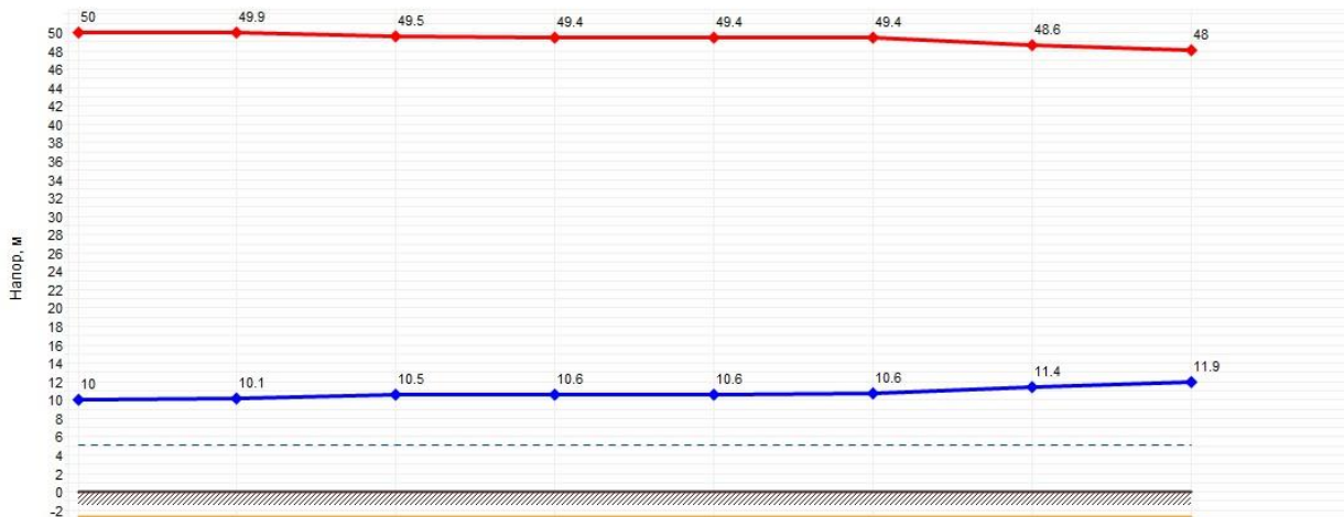
Рисунок 2.43 – Пьезометрический график от Котельной п. Нагорный до самого удаленного потребителя в аварийной ситуации по ул. Молодежная
