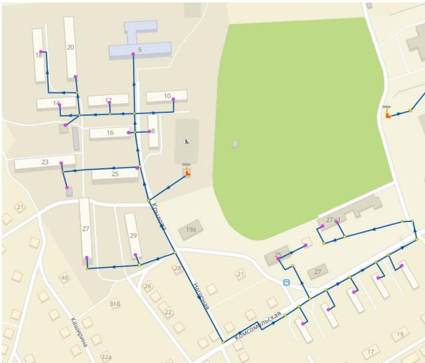
Рисунок 2.29 – Модель системы теплоснабжения Котельной №2 с. Кичигино
